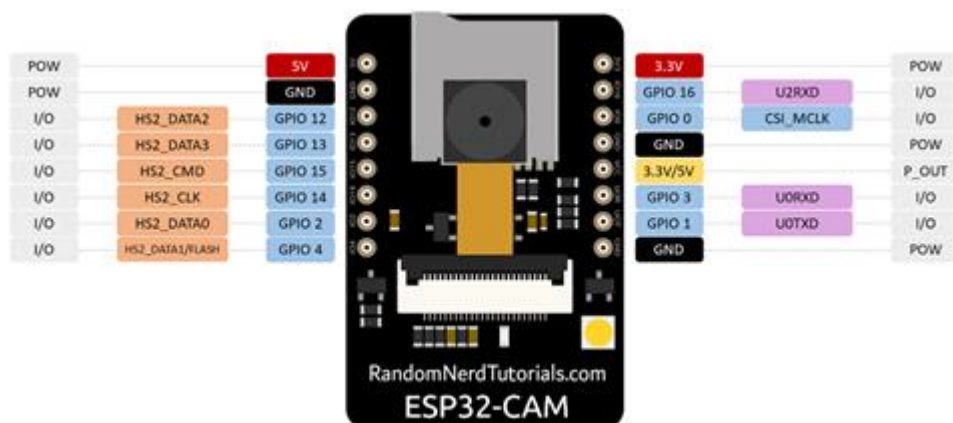
(Рисунок 1.3 – Розпінування модуля ESP32-CAM [Джерело: Random Nerd Tutorials, 2020])
