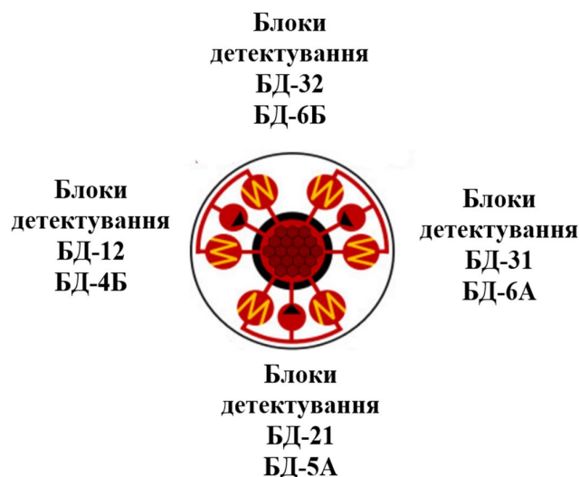
Рис. 1.18. Розташування блоків детектування ССКГО БН-800 і БН-600
