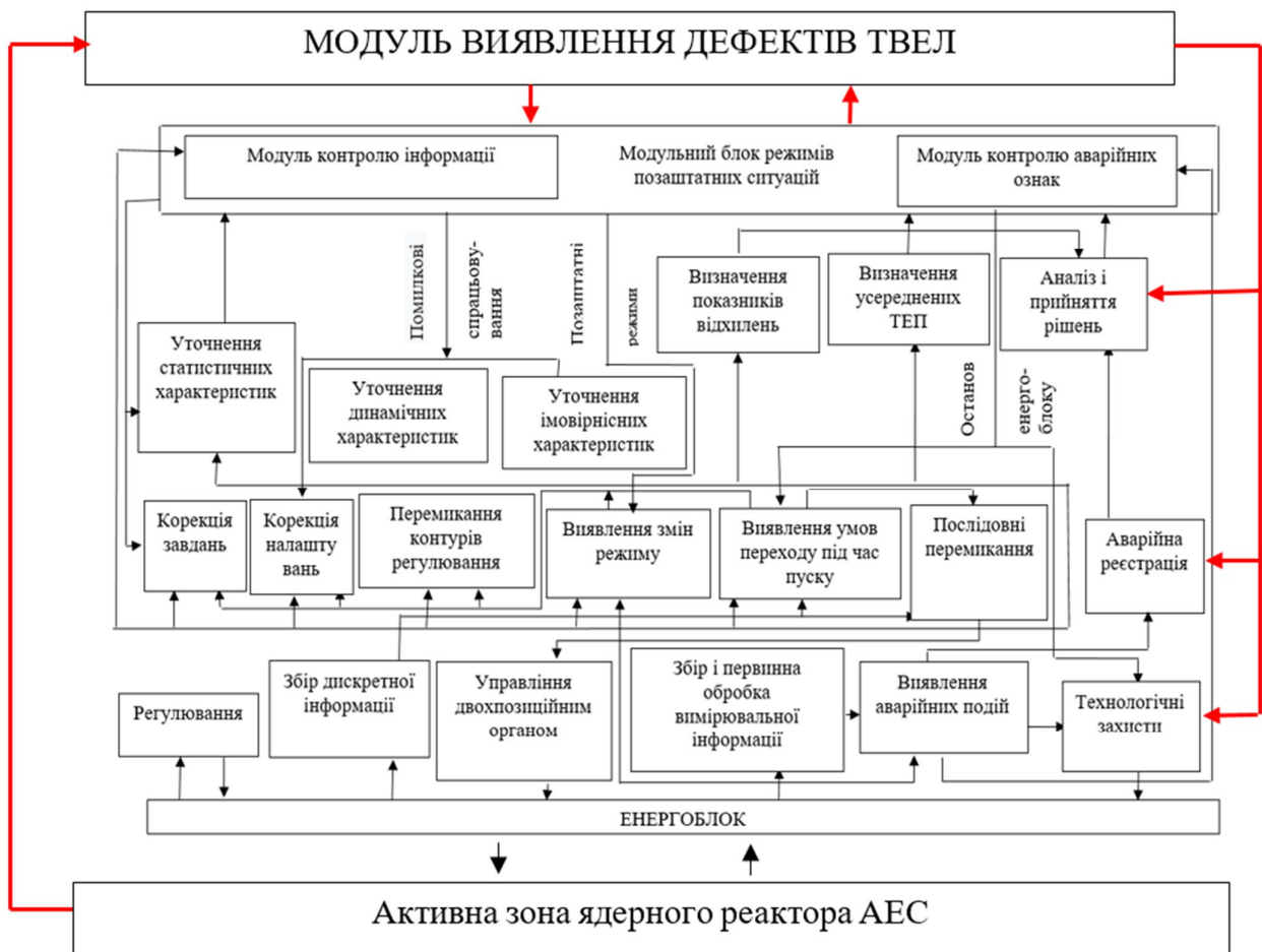
Рис. 4.4. Удосконалення інформаційно-алгоритмічної схеми АСУ ТП енергоблоку при функціонуванні модуля виявлення дефектів ТВЕЛ в нештатних режимах роботи енергоблоку АЕС
