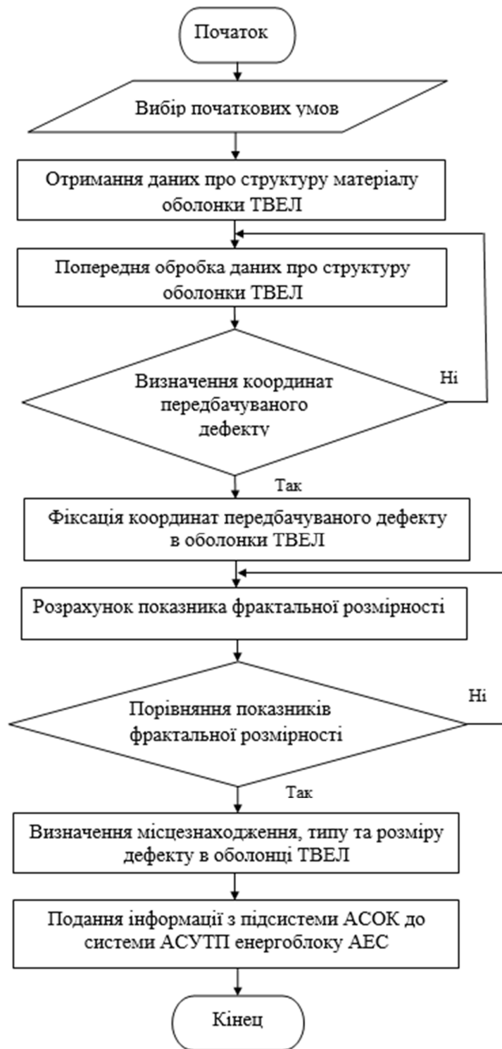
Рис. 4.2. Блок-схема алгоритму фрактального методу контролю системи КГО
