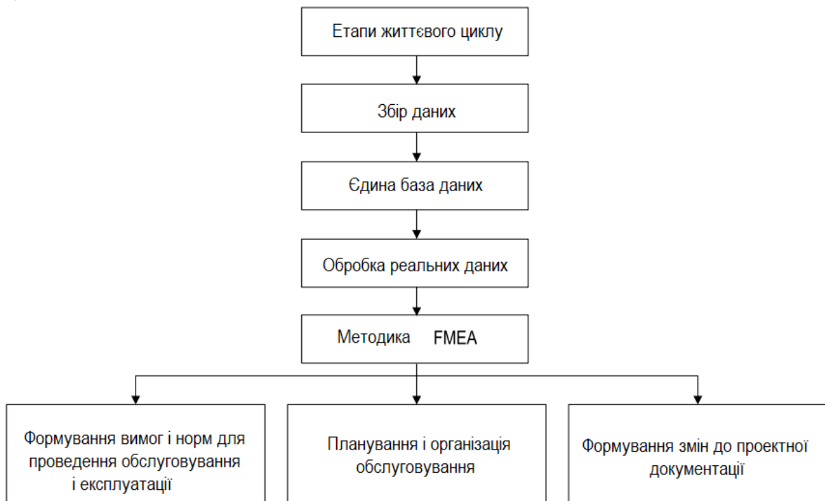
Рис. 1 Структурна схема забезпечення надійності АСУТП
