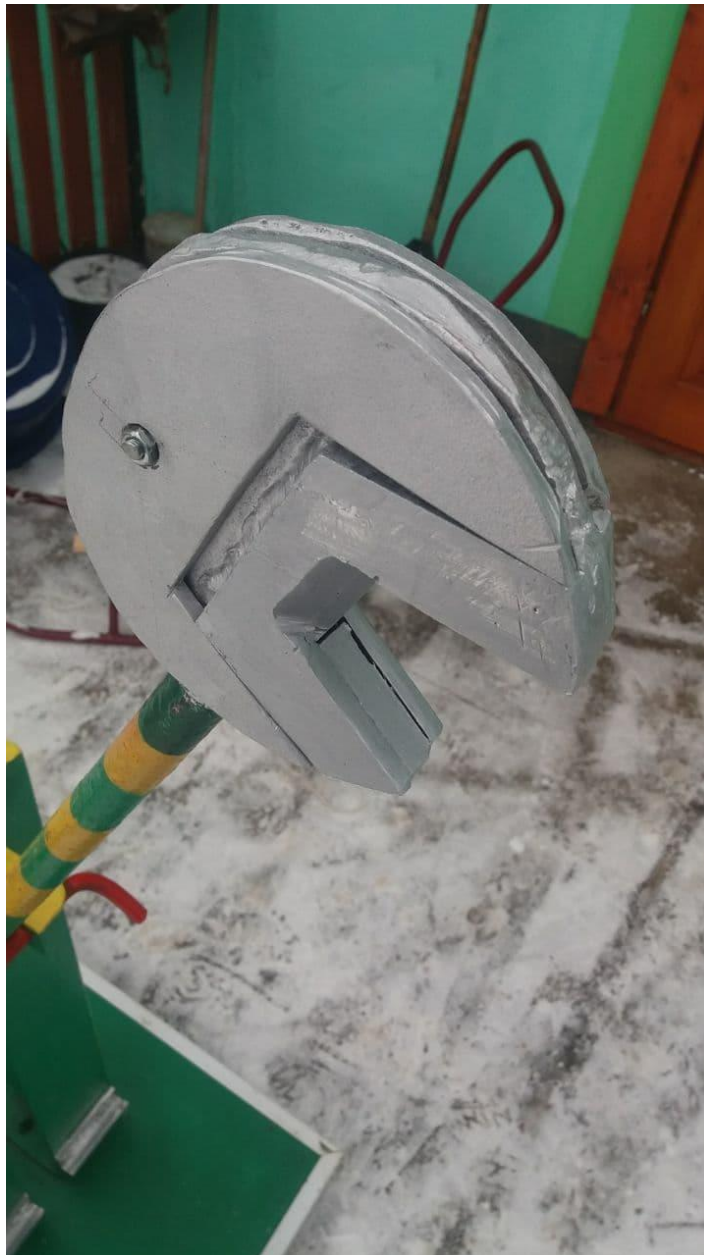
Рисунок 21. Накладки закріплені на молоті
