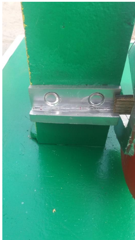
Рисунок 7. Підставка для закріплення зразка
