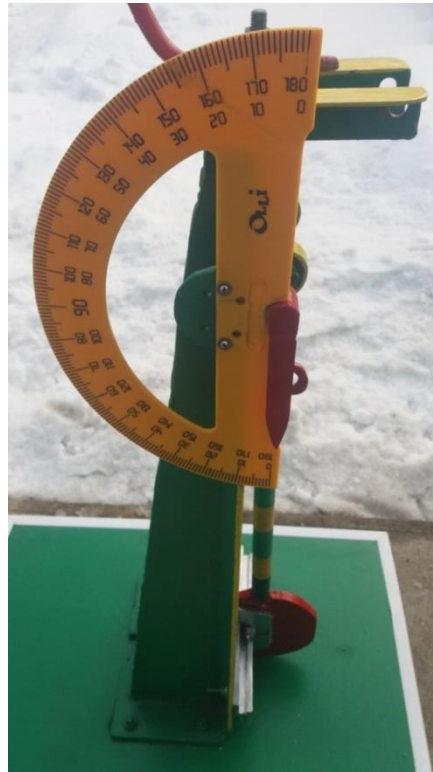
Рисунок 10. Транспорт для вимірювання кута на який відхилиться маятник після зіткнення зі зразком.
