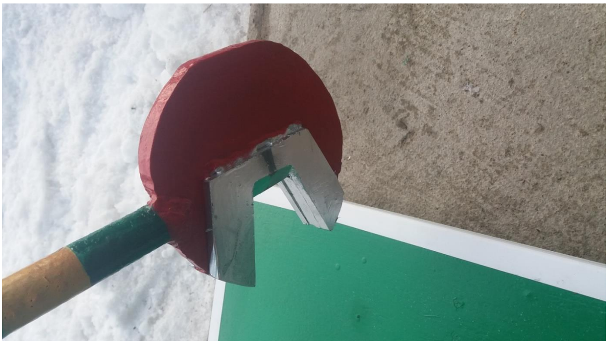
Рисунок 20. Вигляд молотка після вдосконалення
