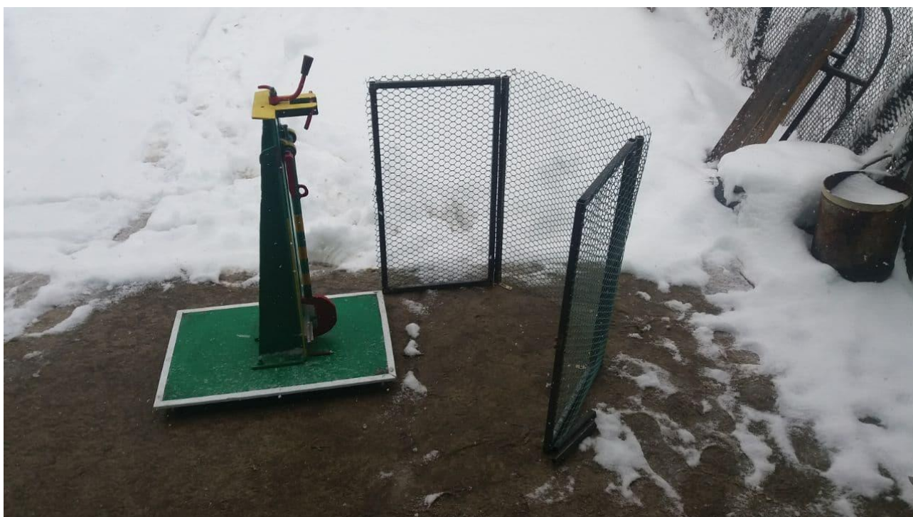
Рисунок 16. Огорожа не прикріплена на установку
