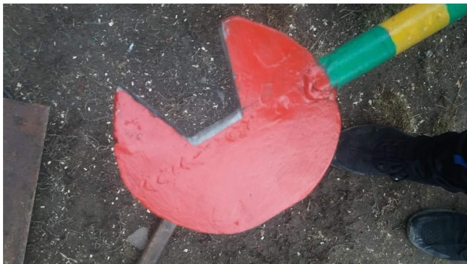
Рисунок 19. Початковий вигляд маятникового молотка
