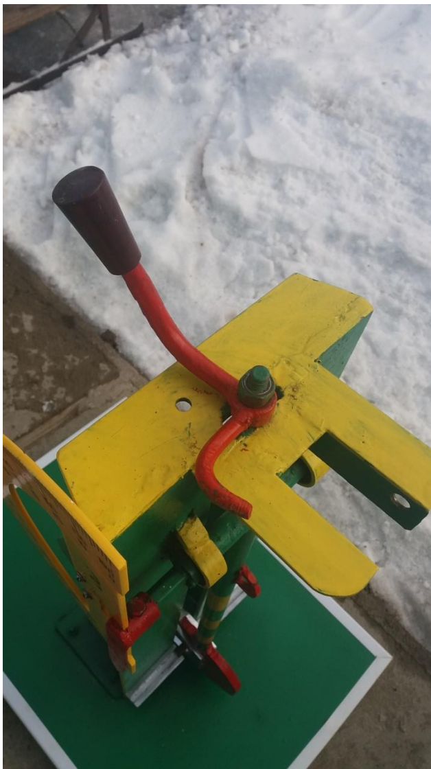
Рисунок 8. Механізм для закріплення маятника і подальшого відпускання
