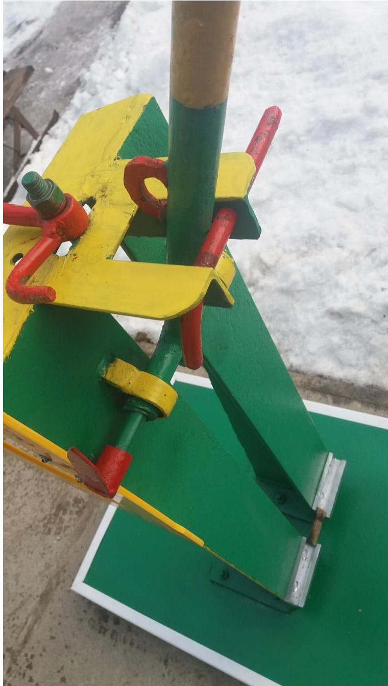
Рисунок 9. Механізм для закріплення маятника у верхньому положенні
