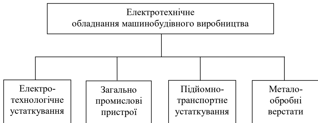
Рис. 1.1. Класифікація електротехнічного обладнання
