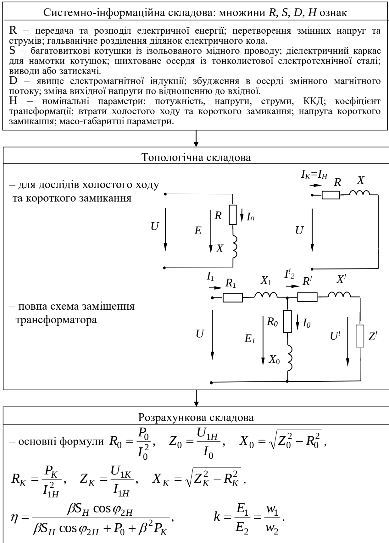
Рис. 2.6. Комплексна трискладова модель змісту навчання елементу промислового обладнання – силового трансформатора
